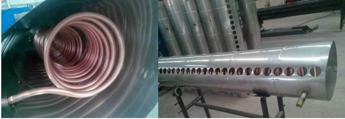
Şekil 3. Isı depolama ünitesinin bileşenleri ve iç görünümü
